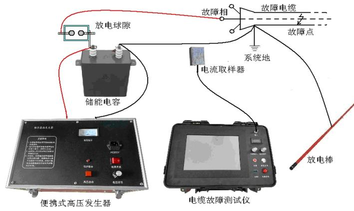
轻型高压发生器测距、定位接线实物图
