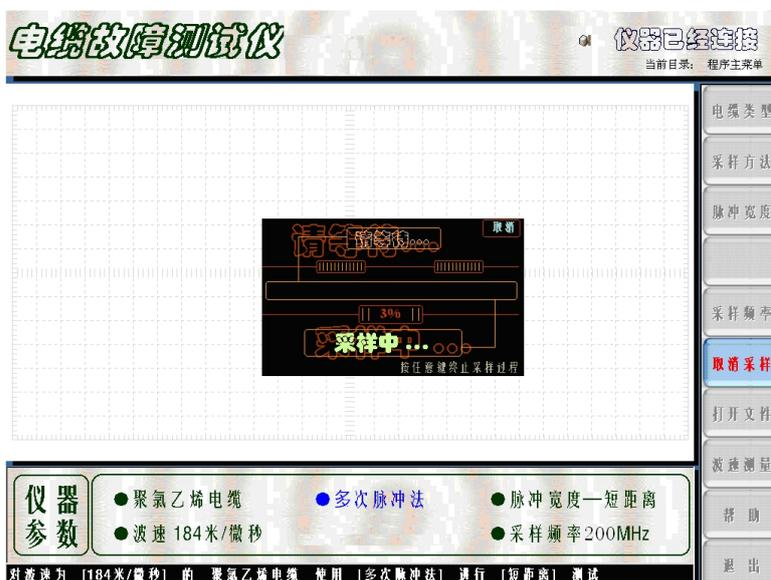
图十三 多次脉冲法采样待测试界面
