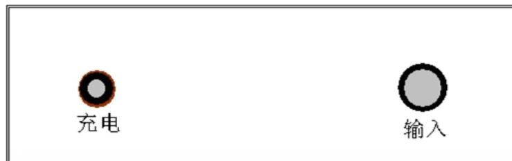
图4 数显同步定点仪后面板
