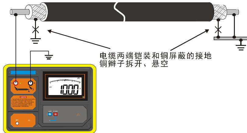
如果目标电缆没有铜屏蔽和铠装，请按照下面的图示接线：
