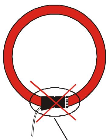
注意：请勿将线缆靠近线圈接口处进行测量，以免造成误差。
