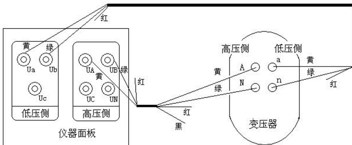
图十九、单相变压器的测试接线
