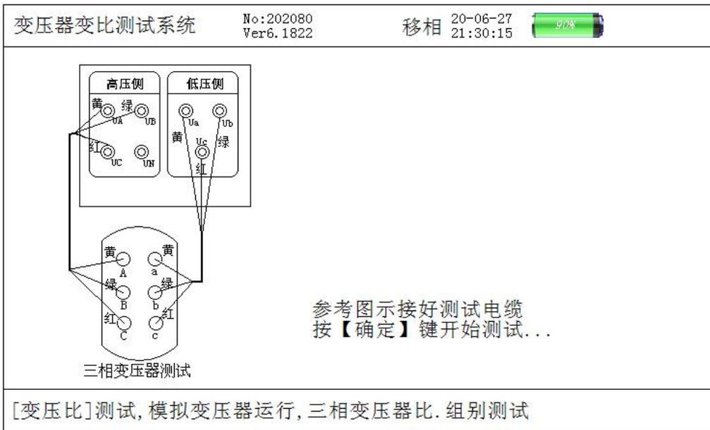
图五、三相变压比测试接线提示屏
