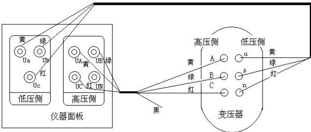
图二十一、斯科特型变的测试接线
