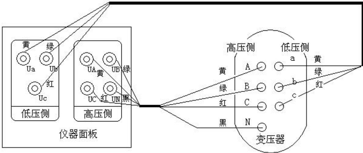
图二十、Z 型变的测试接线
