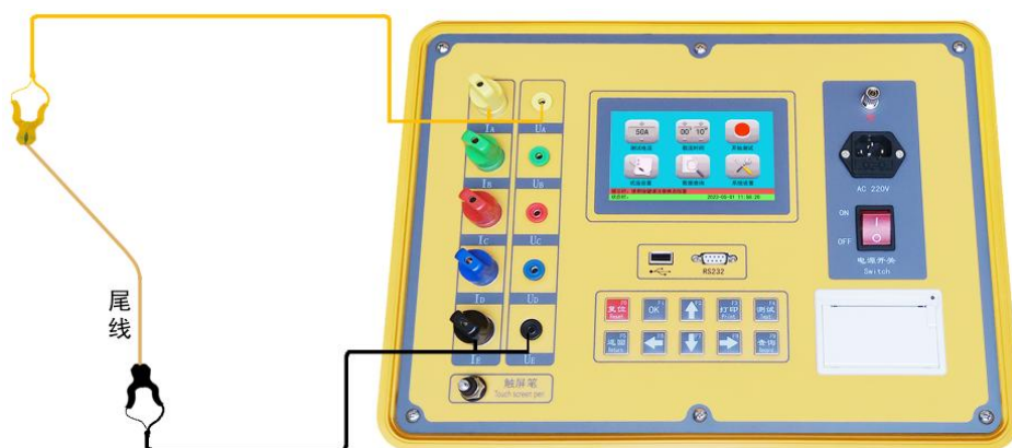
测量无分支接地线
