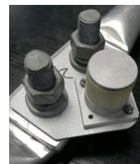
(测温传感器之半成品，装好夹具固定)
