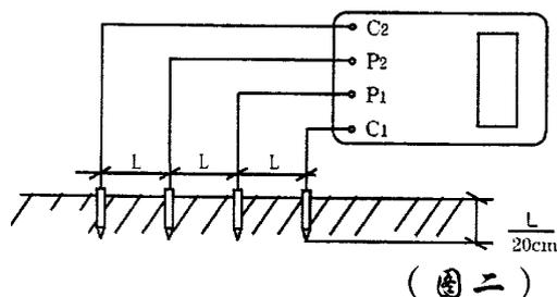
测量时在被测的土壤中沿直线插入四根探针，并使各探针间距相等，各间距的距离为  $L$ ，要求探针入地深度为  $L/20\text{cm}$ ，用导线分别从  $C1$ 、 $P1$ 、 $P2$ 、 $C2$  各端子与四根探针相连接。若地阻仪测出电阻值为  $R$ ，则土壤电阻率按下式计算：
