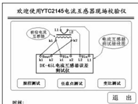
首先参照界面显示的接线图接好测试线路，测试导线请使用厂家配备的专用测试线。然后根据测试需要，可以选择电流互感器规程测试、任意点测试或变比测试。
