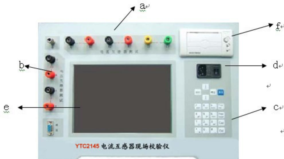
a、 电流互感器测试接线柱:
