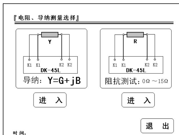
根据测量对象的不同，根据仪器显示的接线图对被测对象以及仪器接线，然后选择导纳测试或者电阻测试。（注：请使用厂家配置的测试导线，仪器的两个K1和两个K2均在被试品端短接。）
