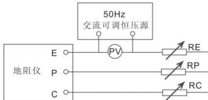
PV—1.5 级低量限交流电压表；E—接地体端子；P—电压（电位）极端子；
