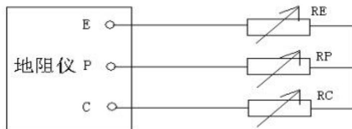
E—接地体端子; P—电压(电位)极端子; C—电流极端子;
