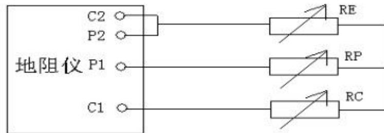
P1、P2—电压（电位）极端子；C1、C2—电流极端子；
