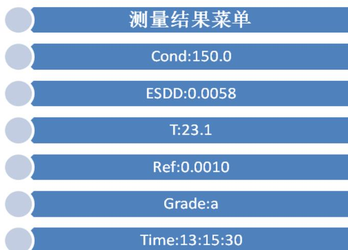
3.1 显示电导率测量结果。例如“Cond: 150.0”，单位 us/cm，微西门子每厘米。
