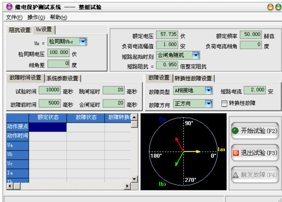
$U_x$  是特殊相，可设定输出  $+3U_0$ 、 $-3U_0$ 、 $+\sqrt{3} \times 3U_0$ 、 $-\sqrt{3} \times 3U_0$ 、检同期  $U_a$ 、检同期  $U_b$ 、检同期  $U_c$ 、检同期  $U_{bc}$ 、检同期  $U_{ca}$ 、检同期  $U_{ab}$ 。前 4 种  $3U_0$  的情况， $U_x$  的输出值由当前输出的  $U_a$ 、 $U_b$ 、 $U_c$  组合出的  $3U_0$  成分乘以各系数得出，并跟随其变化。若选等于某检同期抽取电压值，则在测试线路保护检同期重合闸时， $U_x$  用于模拟线路侧抽取电压。以检同期  $U_a$  为例，在断路器合上状态， $U_x$  输出值始终等于母线侧  $U_a$ ，在保护跳闸后的断开状态， $U_x$  值则等于所设定的检同期电压值，该值可以设定为与此刻的  $U_a$  数值或相位有差，用以检验保护在此种两侧电压有差的情况下检同期重合闸情况。
