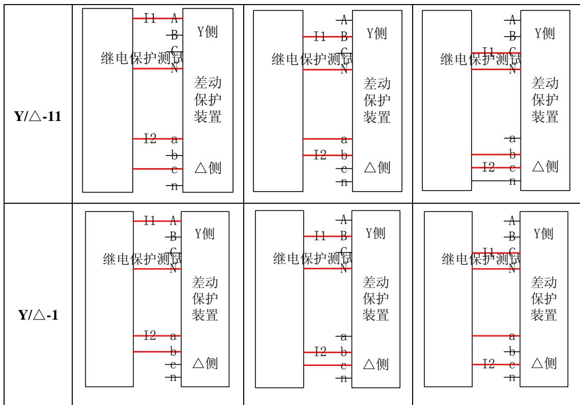
表2:  $\triangle$ 侧相位补偿 (Y侧零序补偿), I1、I2 与保护侧接线
