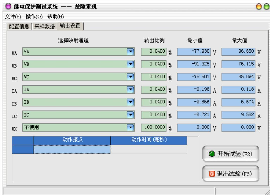
如果录波数据文件中记录的电压电流值为一次回路数据，则需要输入 PT、CT 变比，程序自动计算出各通道的二次回路数据并将其通过测试仪输出。在“输出设置”属性页中对需要输出的通道进行设置，用户可以在“选择映射通道”中将七个通道分别映射至读取文件中的电压或电流通道。在“输出比例”中可调整各通道输出幅值和原始数据的比例关系。
