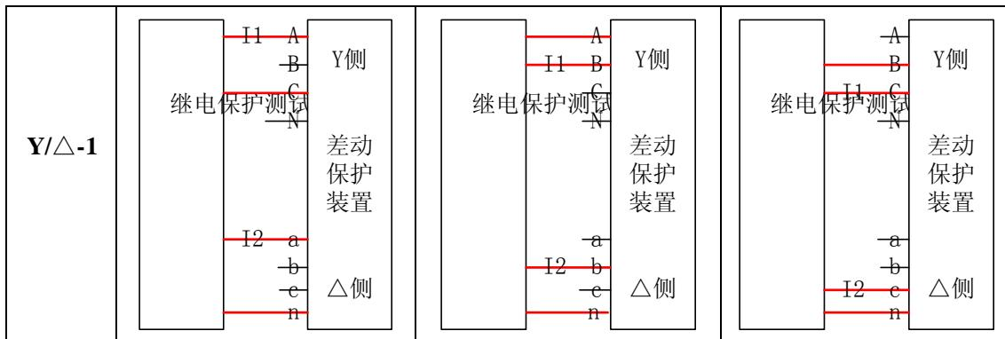
如果测试仪同时提供 6 路电流（高压侧 ABC，中压侧或低压侧 abc）进行差动试验，则试验时测试仪和保护之间的接线大大简化，只需将第一组电流  $I_{abc1}$  引入保护的高压侧，第二组电流  $I_{abc2}$  引入保护的中压侧（或低压侧）。两侧电流三相对称，对应相电流之间的相位差与变压器的接线方式有关。
