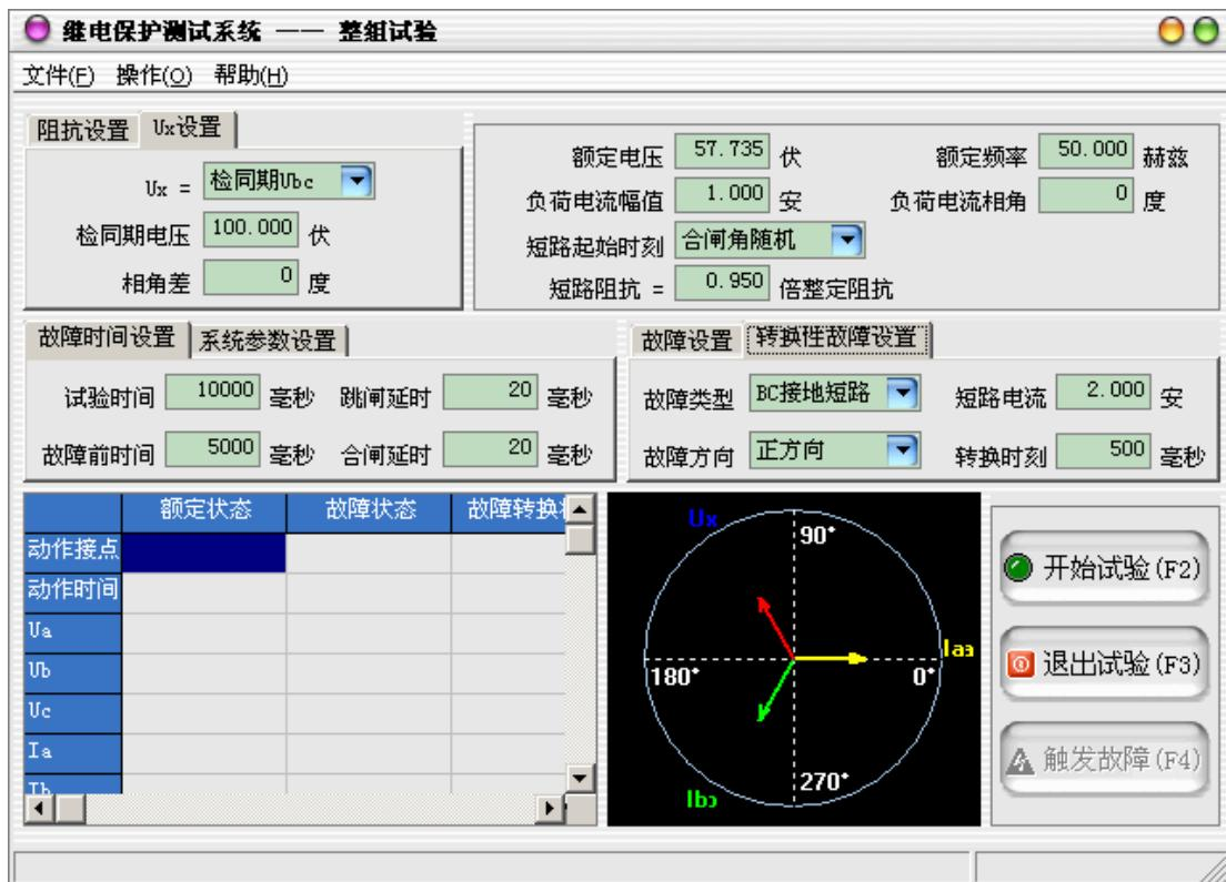
在将“故障设置”中的“转换性故障”选项打上了勾后，则可以进入“转换性故障设置”属性页中对转换性故障进行参数设置。
