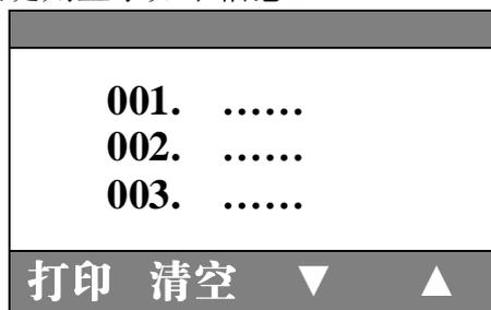
本仪器可存储 255 个数据，按下“打印”键存储的所有数据被全部打印出来。“▼”“▲”键可以上下翻看存储数据。按“清空”键可以删除所有数据，退出按“复位”键。
