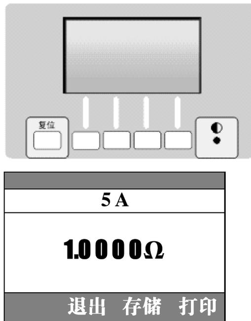
本机的显示器是一个  $128 \times 64$  点阵液晶显示器，电阻的测量值以及操作信息均通过它显示。显示器分为三个区：上层显示当前测试电流；中间的显示区显示测量的电阻值；最下显示仪器按键功能提示。（因工作状态不同，显示的汉字不同，按键的功能也不同，有关它们的详细信息请参阅后面相关部分）。
